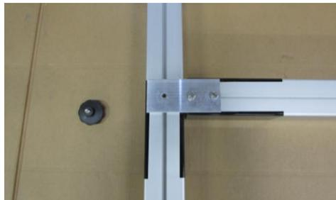
Die Zusatzplatte je Seite mit je 1 Stck. Handrad an der Einsteckmutter am Pfosten befestigen (siehe Foto unten links und rechts). Anschließend die zuvor montierten Sechskantschrauben an der Zusatzplatte fest anziehen (siehe Foto unten rechts). Zuvor am unteren Pfosten demontierte oder gelöste Anbauteile wieder fachgerecht einbauen und befestigen.
