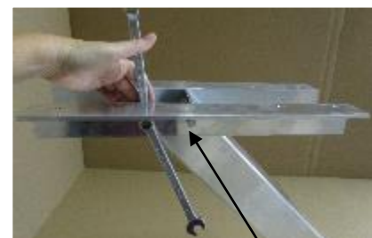
Sechskantschraube M 8 x 16 von außen durchstecken
