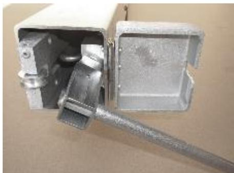
Den Deckel am Mechanikpfosten aufklappen und mitgelieferten Vierkantschlüssel auf den Zapfen oben an der Spindel setzen. Nun den an der Spindel befindlichen Seilhaken durch Verwendung des Schlüssels bis ganz nach oben drehen.
