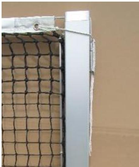
Dann die Netzhaltestange von oben durch die Netzhaken schieben. Dabei das Netz am Rand gleichmäßig auf die Netzhaltestange auffädeln. Den abgewinkelten Steg der Netzhaltestange zum Pfosten drehen. Sofern zusätzliche Befestigungseile am Netz vorhanden sind, diese um die Pfosten führen und befestigen.
