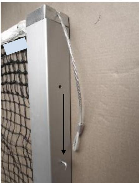
Bei zu geringer Netzspannung kann der Winkelhaken am Gegenpfosten in die untere Bohrung umgesetzt werden. Zunächst das Seil am Mechanikpfosten wieder komplett entspannen. Danach die Schlaufe am Winkelhaken aus- hängen, Winkelhaken losschrauben, in die untere Bohrung versetzen und wieder in die rückseitige Einsteckmutter einschrauben. Dann das Spannseil wieder einhängen und den Spannvorgang am Mechanikpfosten wieder- holen.
