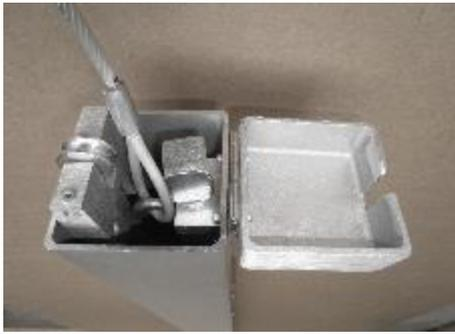
Das Spannseil über die Umlenkrolle führen und am Seilhaken einhängen.
