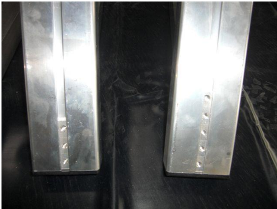
Bild 29: An den Mittelunterstützungen vorne Kunststoffkappen aufstecken. In die Nut der 2 Stk. Mittelunterstützungen für die äußere Montage erst 4 Stk. Einsteckmutter M6x20 von hinten einschieben, dann 1 Stück M8x20. In die restlichen Mittelunterstützungen für die mittlere Montage (2-4 je nach Kabinenbreite) erst 2 Stk. Einsteckmutter M6x20 und dann 1 Stk. M8x20 schieben.
