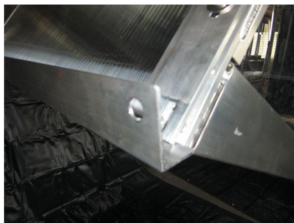
Bild 25 + 26: Winkel 50x30x2mm an der Dachtraverse und den Seitenteilen mit Linsenschrauben DIN 85 M6x20 und Unterlegscheiben DIN 9021 Ø 7,4mm befestigen. Jetzt können auch sämtliche Schrauben, die vorher nur leicht eingedreht wurden, fest angezogen werden.
