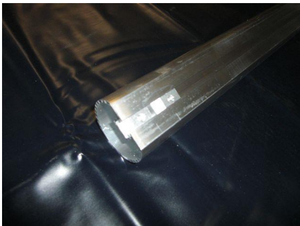
Bild 15: Einsteckmuttern M6x20mm in Rundrohr mit Nut (= Dachtraverse) einschieben. (bei 3m-Kabine 2 Stück; bei 4m-Kabine 3 St.; bei 5m-Kabine 4 Stück).
