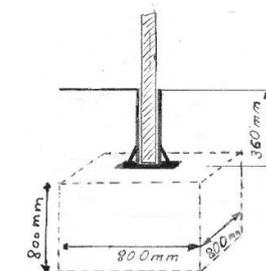
2. Fixer les manchons **“à bétonner”** conformément à la dimension du terrain. Nous recommandons de les fixer négativement vers l’extérieur avec une inclinaison de 1°.
