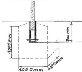
1. Fixer les manchons **“à cheviller”** sur le béton conformément à la dimension du terrain. Considérer que les manchons sont faits avec une inclinaison négative de 1°. On a gravé “chiffre 1” sur la plaque de fond du manchon qui doit pointer vers l’intérieur en direction filet.
