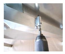
Auf einem der beiden Haspelträger ist eine Rohrhülse mit Gewinde M8 aufgeschweißt. Durch die Hülse hindurch mit einem Bohrer Ø 9,5mm eine Bohrung für die Arretierung an einer beliebigen Stelle in das runde Seitenteil bohren.
