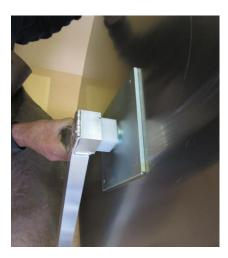
Zum Einsetzen der Haspel die beiden Seitenteil-Rahmen leicht nach außen drücken und die Polyamid-Buchsen in die quadratischen Aufnahmen einführen. Ein Seitenteil ist mit einer aufgeschweißten Hülse für eine spätere Haspelarretierung ausgestattet. Dies hat jedoch beim Aufstecken der Seitenteile vorerst keine Bedeutung.
