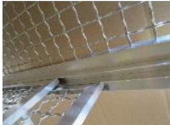
Führungsschiene Schiebetür im Oberteil
