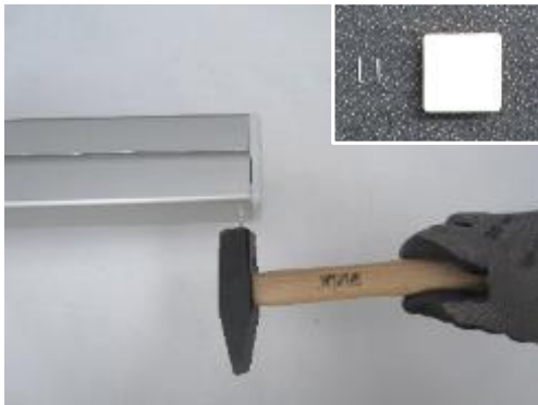
Montage Pfostenverschlusskappe quadratischer Pfosten:
